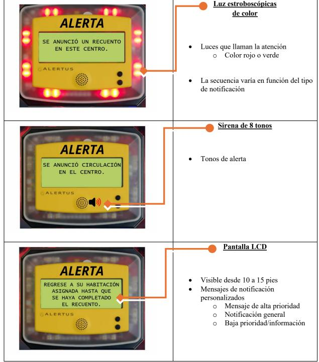
Estas balizas utilizarán una combinación de la sirena de 8 tonos, la luz estroboscópica de color y la pantalla LCD, utilizando diferentes patrones/configuraciones para cada notificación que se active.
