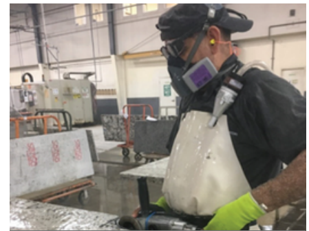
Profissional do setor fabricação de bancadas de pedra usando uma esmerilhadeira para fazer o acabamento de uma bancada.
