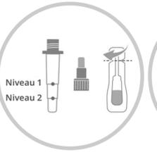
Repérez les deux niveaux sur le tube vide, puis pressez, dans le tube vide, la solution encapsulée
