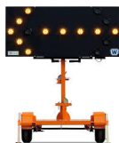
Fermeture de la voie de droite - fusion à gauche
