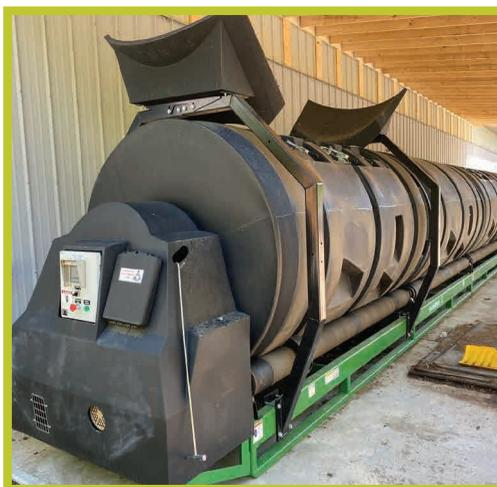
Système de compostage en cuve de type tambour rotatif
