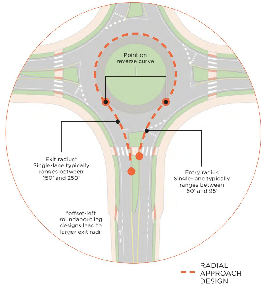
**FIGURE 5-6: MULTILANE ROUNDABOUT LEG GEOMETRY ELEMENTS**
