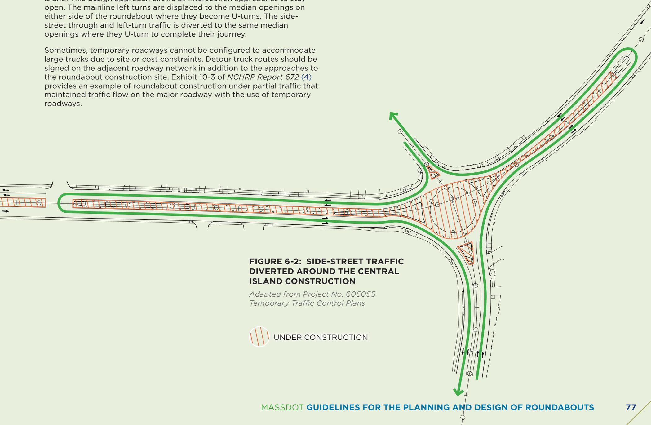
**FIGURE 6-2: SIDE-STREET TRAFFIC DIVERTED AROUND THE CENTRAL ISLAND CONSTRUCTION**
