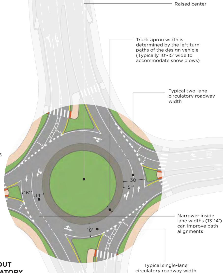
**FIGURE 5-4: ROUNDABOUT WITH VARIABLE CIRCULATORY ROADWAY WIDTHS**
