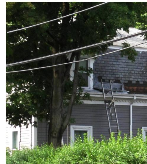
Um carpinteiro de 29 anos foi eletrocutado quando a escada de alumínio que carregava fez contato com o cabo eléctrico. O carpinteiro estava retirando uma escada de 13 metros de altura da frente de uma residência de três famílias quando a escada fez contato com o cabo eléctrico que estava a 8 metros do chão.
